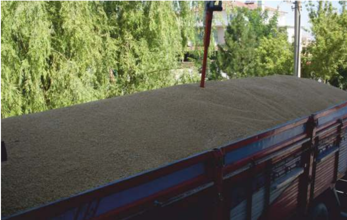
Otomatik numune sondası ile numune alımı
