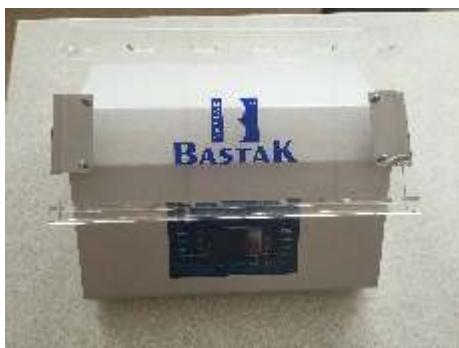
3,2 gram unun, bromfenol çözeltisi ve özel olarak hazırlanmış laktik asit çözeltileri ile karışımı sonucu un taneciklerinin gluten kalitesine göre şişmesi ve belirli zaman içerisinde çökmesiyle miktarının ölçülmesi işlemidir. Cihaz her iki yana dakikada 40 salınım hızla sallanarak çalışmaktadır.
