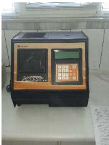
GAC 2100 gelişen teknolojisinin sayesinde, buğday ve diğer hububatlarda; Rutubet, sıcaklık ve hektolitre ölçümelerini hızlı ve hassas olarak gerçekleştirebilmekte. Yazıcısından çıktı alınılmaktedir.
