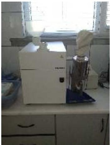
Laboratuvar dejirmeni 3100 darbe tipi dejirmendir. Buğday, tüm tahıllar ve yağlı tohumları yüksek hızla %25'e kadar rutubetli numuneleri rahatlıkla öğütebilir. Gluten, Gluten index, Protein, yağ ölçümlerine uygun numune hazırlar. Vakum sistemi çevreyi tozdan korur.
