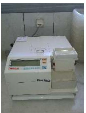
Buğday unu ve öğütülmüş ürünlerde; protein, nem, kül tayinlerinin 10 saniyede belirlenmesinde kullanılır. Hafızasında 103 ürünlük kalibrasyon bulunur. Dijital ekranlı olup yazıcısı ve klavyesi üzerinde mevcuttur.
