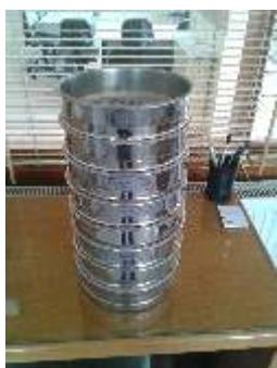
Alınan numunenin ilk etapta yabancı maddelerden ve kırık tanelerden ayrışmasında kullanılır. Fiziki analizde numune hakkında ilk değerlendirme yapılmış olur.
