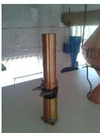
Alınan buğday numunesinde yapılan test sonucu o numunenin hektolitre bazında yüzde değerini verir. Borsamızda elektronik ve klasik hektolitre cihazları mevcut olup, genelde elektronik cihazlarla ölçüm yapılmaktadır. Klasik cihazın tartım işlemi elektronik terazi ile yapılmaktadır. Tartı cihazı çok hassas olup 10 mg'a kadar tartım yapmaktadır.
