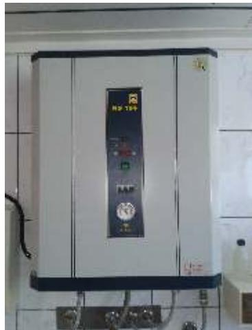
Laboratuvar çalışmalarında, bazı araştırma ve standart işlemlerde ihtiyaç duyulan arıtılmış su temininde kullanılır. Şehir şebeke suyu ile çalışan metalik su damıtıcıları, suyu kaynatıp önce buharlaştırmakta daha sonra buharlaşan suyu tekrar yoğunlaştırarak damitik su elde etmektedir. Cihazın kapasitesi 4 lt/saat' tir.
