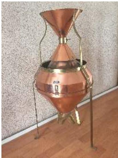
Tamamen bakırdan imal edilmiş olup numuneyi homojen olarak iki eşit parçaya böler, alt kısmında bulunan iki adet toplama kabında işleme hazır hale getirilir.
