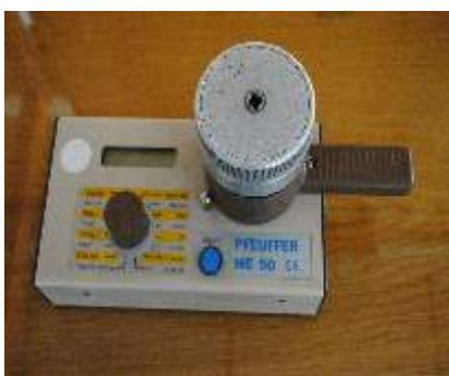
Elektronik olarak çalışan portatif olarak taşınabilen nem ölçme cihazıdır. Alınan numuneyi dökme sistemi ile değil ezerek veya ufalayarak yaptığı için hata payı en az seviyededir. Un ile 13 çeşit hububat ve yağlı tohumların nen ölçüm işine 5 saniye gibi kısa bir zamanda ulaşılabilir mektedir.
