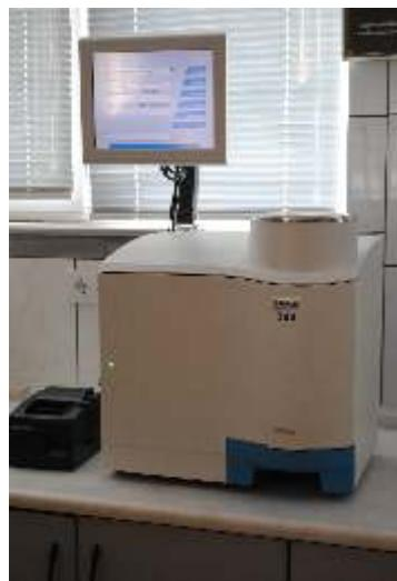
Inframatic 9500 cihazında NIT (Yakın Kızılıötesi İletimi) tekniği kullanılmış ve birçok ürününde birçok parametrenin 1 dakikadan kısa sürede alınmasını sağlamıştır. Aynı zamanda günümüz teknolojisinin faydalardan "uzak kontrol" mekanizmasını kullanarak ortak ağda buluşan cihaz sistemleri yapısını başarıyla uygulamıştır.
